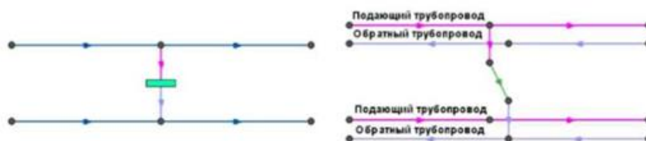
Рисунок 24 - Однолинейное изображение (слева) и внутреннее представление (справа) сети с переключателем между подающим трубопроводом одного участка и обратным трубопроводом другого участка.
