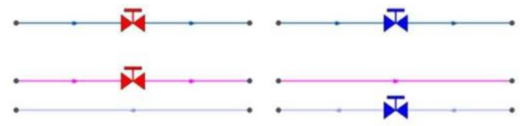
Рисунок 28 - Однолинейное изображение (вверху) и внутреннее представление (внизу) сети с регуляторами давления.
