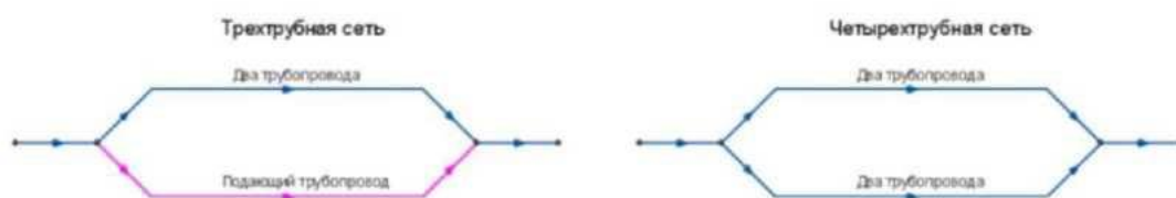
Рисунок 9 - Изображение трехтрубной и четырехтрубной сети.
